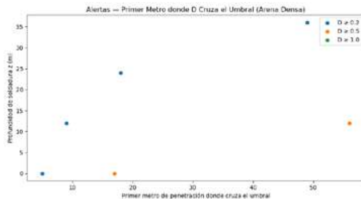
Figura 5. Profundidad de soldadura y primer metro de penetración en que se alcanzaron los umbrales normativos.
